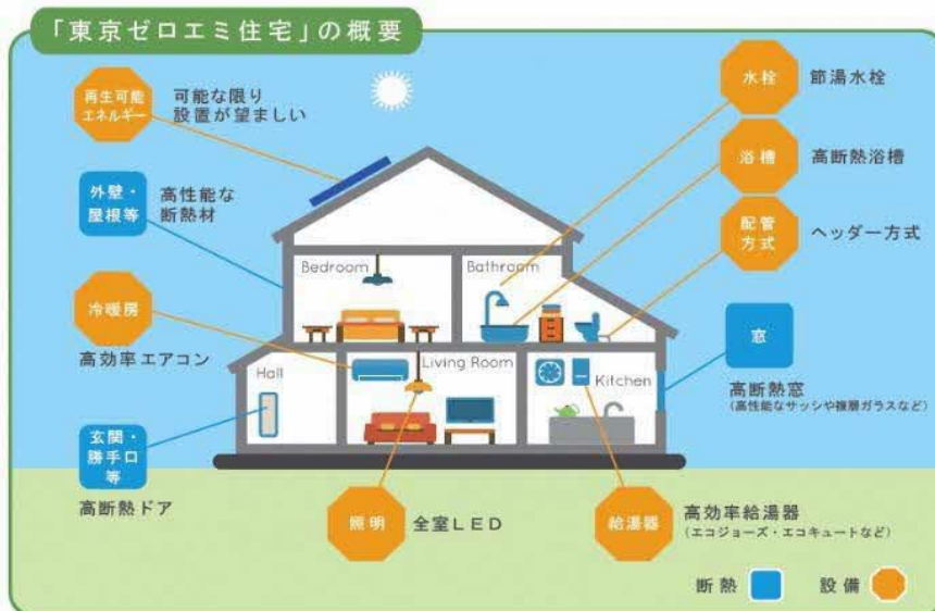
「東京ゼロエミ住宅」の概要 (出典：東京都環境局Webサイト)
