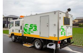
路面下空洞探査車
